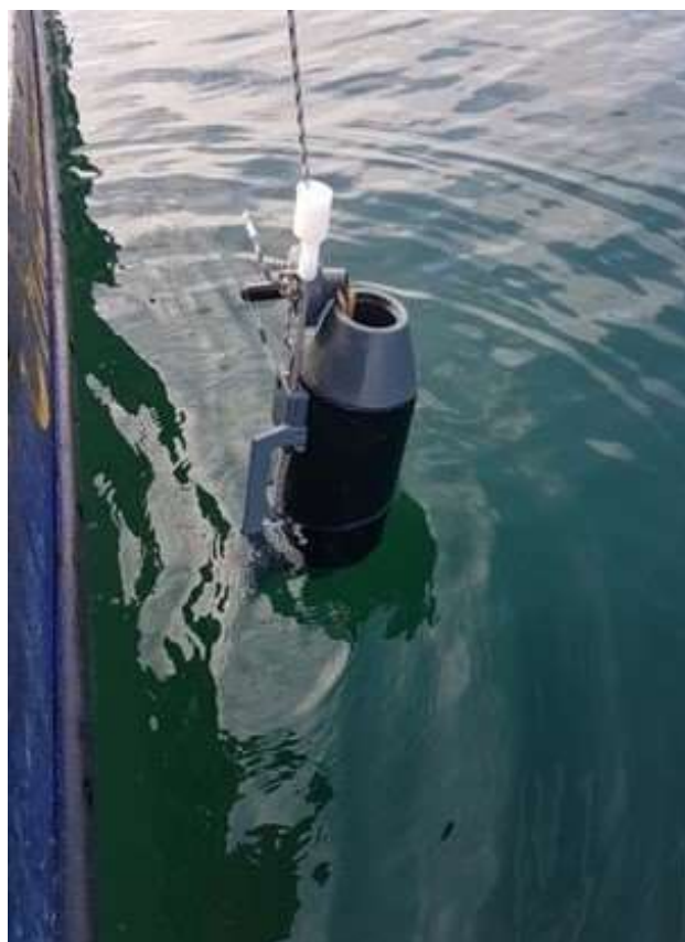
Fotografía 4.2. Imagen referencial de la obtención de muestras de la columna de agua a través de una botella modelo Niskin. PVA Modernización del Puerto de Coquimbo. Monitoreo Semestral N° 02, Fase de Operación, invierno 2024.
